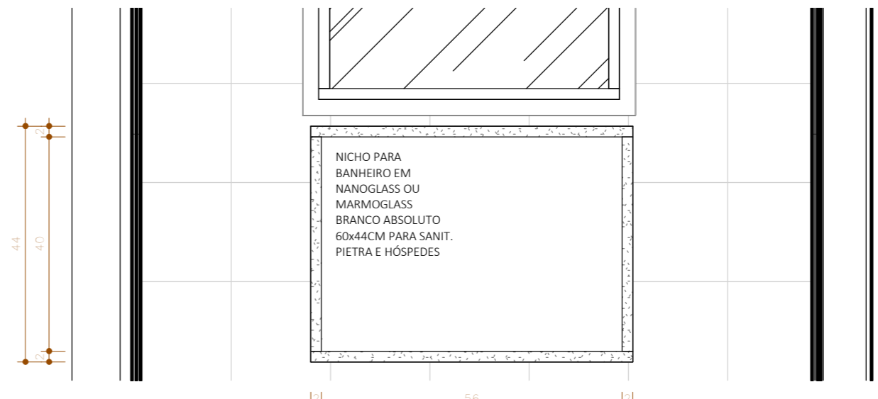
6 SANIT. SUÍTE HÓSPEDES - VISTA FRONTAL NICHO ESCALA 1:10
